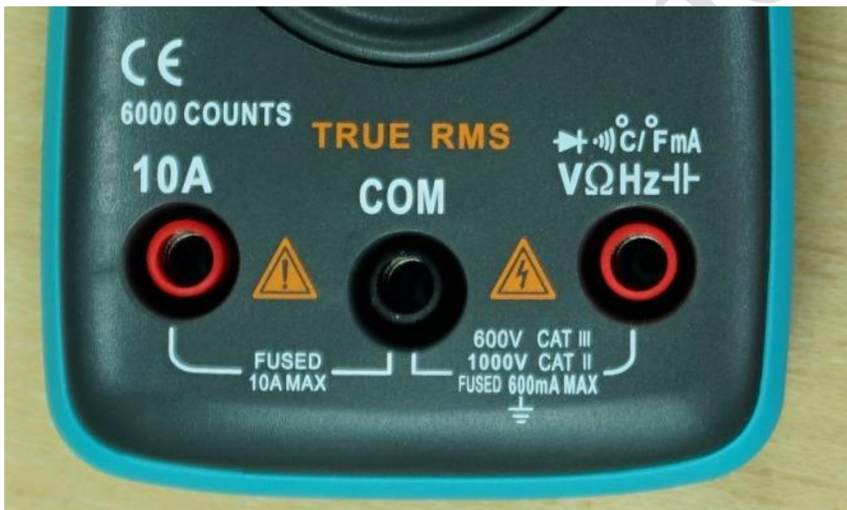
Obr. č. 4: Zařazení DMM do CAT bývá viditelně označeno.
