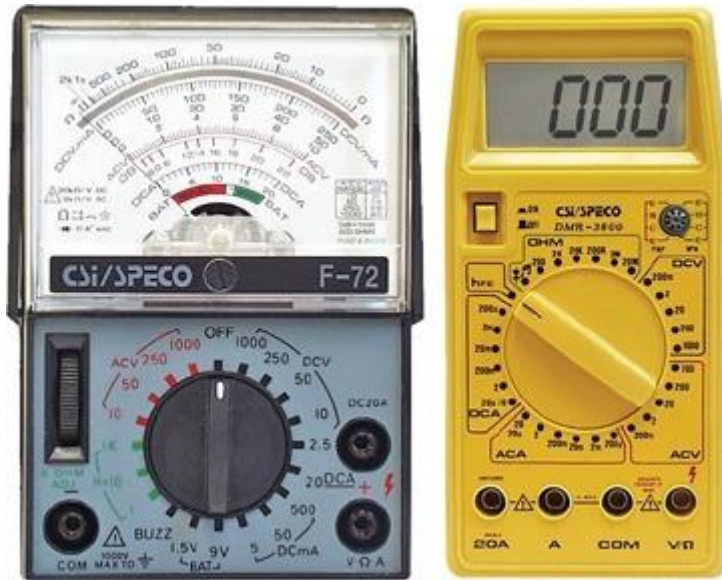
Obr. č. 1: Porovnání snadnosti čtení na analogovém a na digitálním přístroji.
