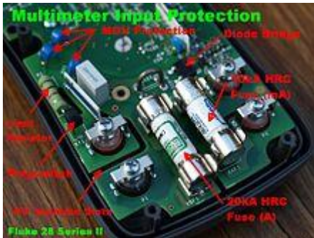
Obr. č. 5: Příklad ochrany vstupu speciálními pojistkami na multimetru Fluke 28 Series II s zařazením do CAT-IV.
