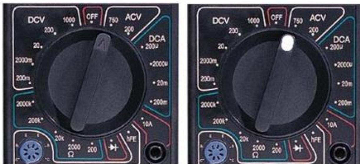
Obr. č. 4: Úprava kapkou barvy zvyšující viditelnost nastavené polohy přepínače
