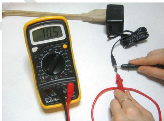
Obr. č. 9: Kontrolu střídavého napětí provádíme jen na nízkourovňovém vývodu zdroje.
