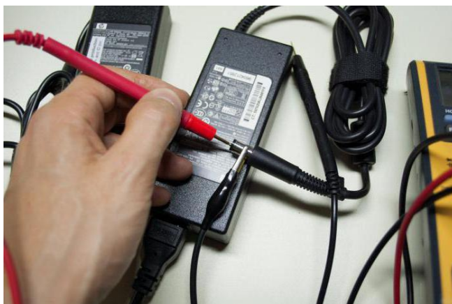
Obr. č. 20: Měření zdroje provádíme vždy na nízkonapěťové straně
