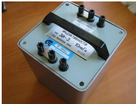
Obr. č. 41: Toroidní měřený prvek charakteru indukčnosti pod 100 \mu\text{H} s potlačením vlivu indukčnosti přívodů.
