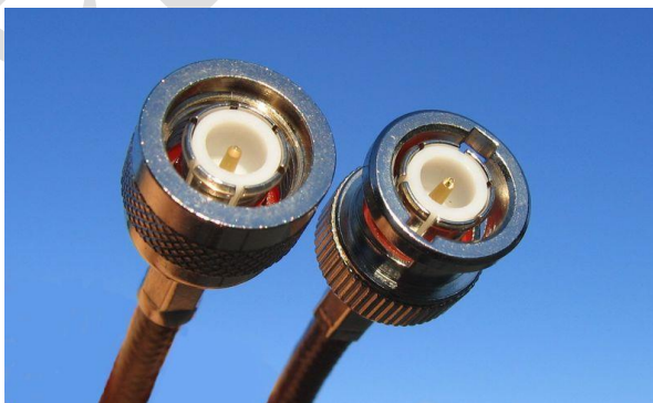
Obr. č. 18: Na obrázku vlevo konektor TNC se závitem, vpravo klasický BNC
