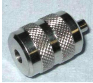
Obr. č. 9: Kalibrační etalonová měrka pro N-konektory
