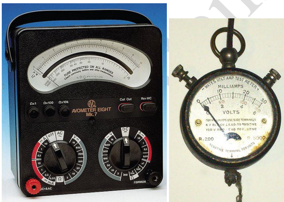
Obr. č. 32: Avometr a hodinkový typ DMM z roku 1920
