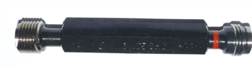
Závitový trn s dobrou a zmetkovou stranou
