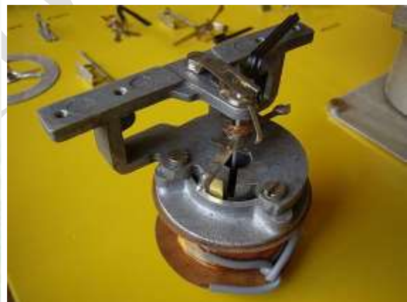
Obr.8: Princip elektromagnetického přístroje
