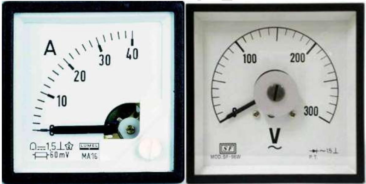
Obr.3: Značky na přístroji, příklad
