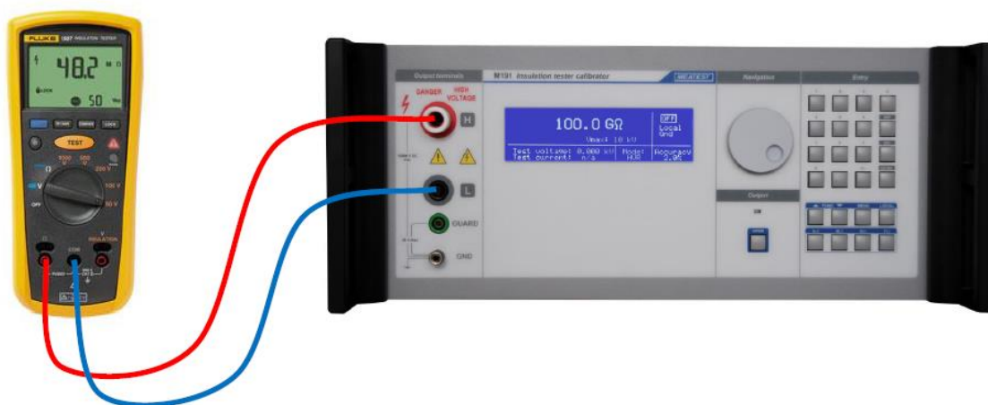
Obr. č. 11: Příklad připojení dvousvorkového megaohmmetru ke kalibrátoru M 191
