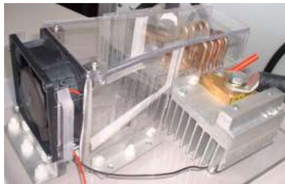
Obr. č. 6: Ukázka provedení externího nuceného chlazení (podle AKL ESZ, Německo)
