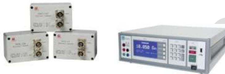
Obr. č. 16: Příklad možných zařízení k numerickému příkladu, vlevo etalony 100 GΩ vpravo teraohmmetr
