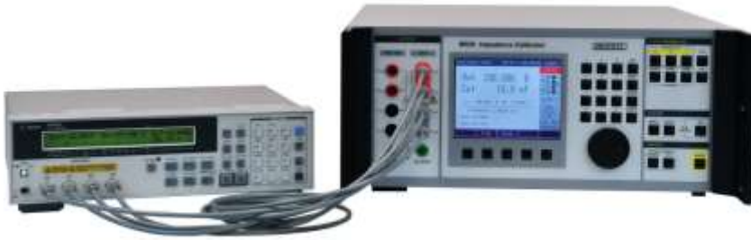
Obrázek č. 32: Kalibrace 4TP mostu s kalibrátorem impedance Meatest M 550
