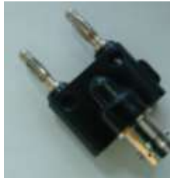
Obrázek č. 15: Přechod banánek-BNC a T kus BNC v provedení Y (výhodnější než obvyklé provedení T)
