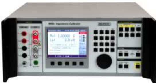
Obrázek č. 28: Kalibrátor impedance Meatest M 550
