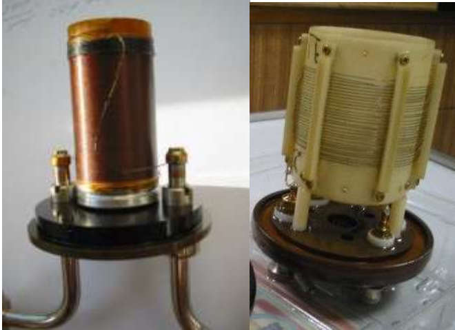
Obrázek č. 25: Provedení etalonu R jen pro DC a provedení pro DC a AC do 10 kHz
