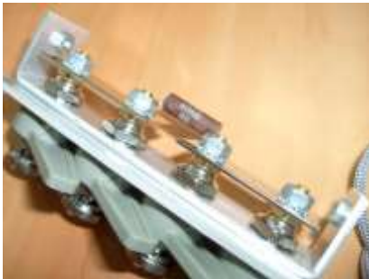
Obrázek č. 26: Provedení etalonu s metalizovanými R
