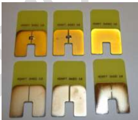
Obrázek č. 2: Ukázka provedení dvousvorkového etalonu pro měřič se vstupem kleštinami
