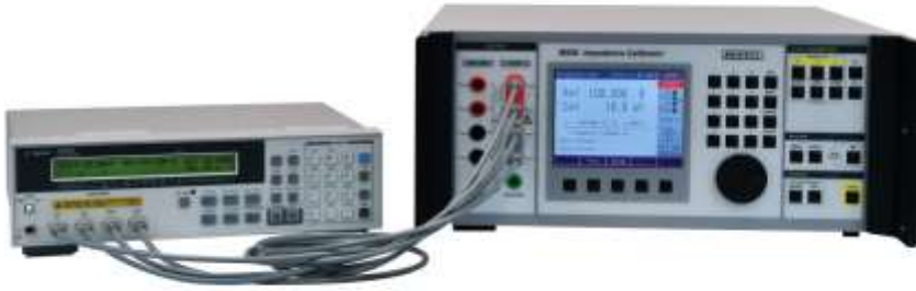
Obrázek č. 29: Kalibrace 4TP mostu s kalibrátorem impedance Meatest M 550
