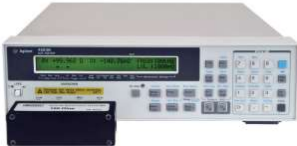
Obrázek č. 7: Čtyřpárové etalony připojené přímo na most bez kabelů.
