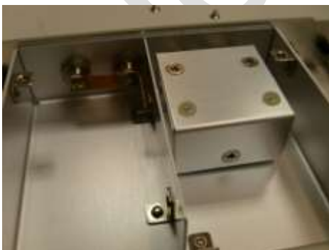
Obrázek č. 27: Nyní již nepoužívané provedení s aktivním stíněním.
