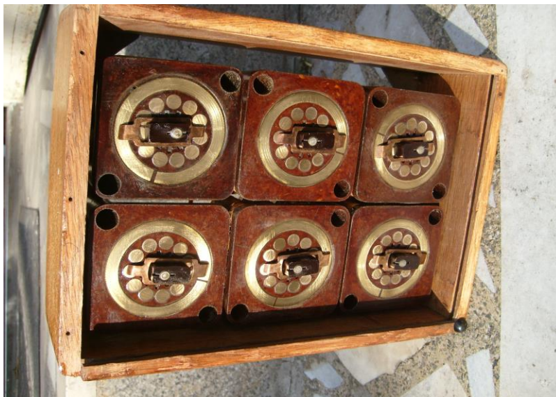
Obr. č. 1: Ukázka provedení dekády Metra, u které výrobce předpokládal čištění přepínačů před kalibrací
