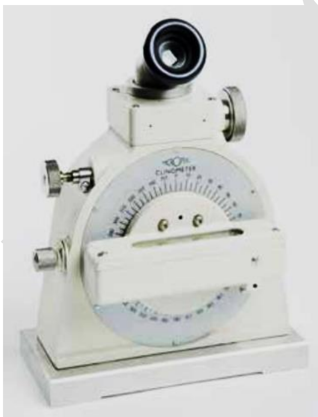
Obr. č. 1: CLINOMETER TB 100 od firmy Taylor-Hobson
